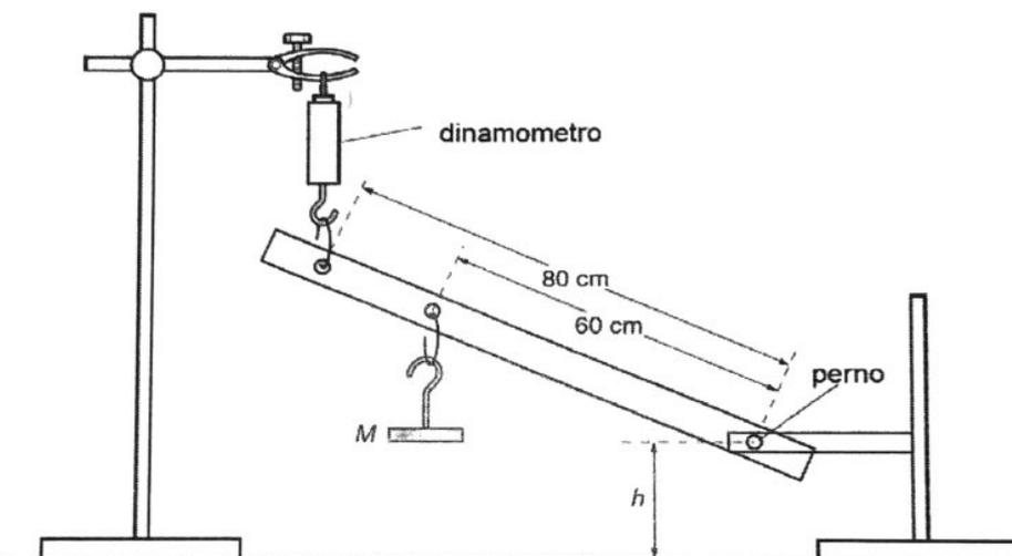
Assembla l'apparecchiatura che trovi sul tuo tavolo seguendo le indicazioni della figura qui sopra. Il perno si trova ad un'altezza  $h$  dal piano del tavolo su cui poggiano i sostegni. Per garantirti che non cambi l'angolo che l'asta forma con l'orizzontale potrai mantenere fissa la distanza dal piano orizzontale di uno dei punti dell'asta o rigidamente collegati ad essa, per esempio la base del portamasse che va mantenuta a distanza  $h$  dal piano del tavolo di lavoro.
