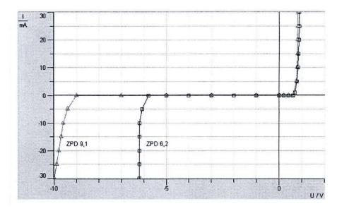
In polarizzazione diretta i diodi Zener si comportano come i diodi al Si e al Ge. In polarizzazione inversa esiste un potenziale di soglia, detto di "breakdown" a cui si manifesta un effetto "valanga" e la resistenza del diodo diventa piccolissima. Aumentando la corrente la ddp ai capi del diodo rimane
