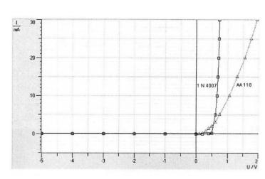
In polarizzazione diretta (U>0). Dalla curva sperimentale possiamo calcolare il "potenziale di soglia"  $U_s$  come quel potenziale esterno applicato al di sotto del quale la corrente nel diodo è praticamente zero, mentre al di sopra del quale la corrente aumenta molto rapidamente con la tensione applicata. Il potenziale di soglia  $U_s$  si determina interpolando con una retta due punti consecutivi delle nostre misure che corrispondono ad una corrente significativa.
