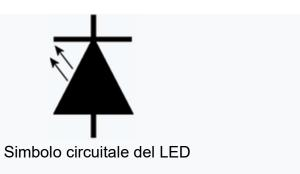
Il colore o frequenza della radiazione emessa è definito dalla distanza in energia tra i livelli energetici di elettroni e lacune e corrisponde tipicamente al valore della banda proibita (energy gap) del semiconduttore in questione. L'esatta scelta dei semiconduttori determina dunque la lunghezza d'onda dell'emissione di picco dei fotoni e l'efficienza nella conversione elettro-ottica e quindi l'intensità luminosa in uscita.
