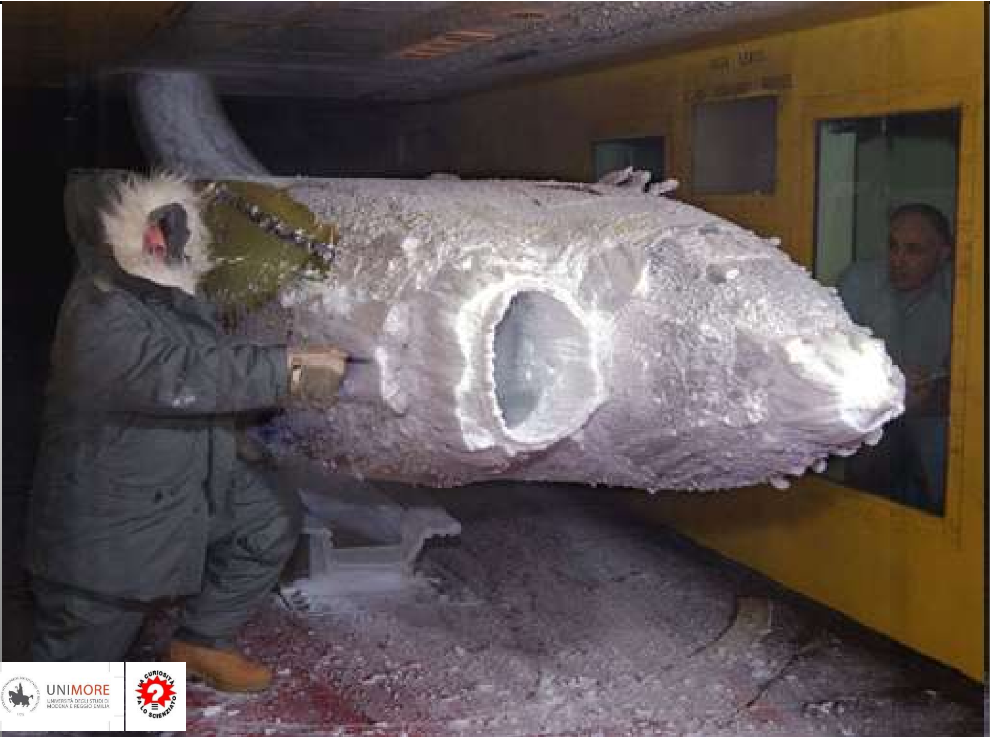
Test sugli effetti della formazione di ghiaccio sulla superficie del veicolo spaziale durante il volo
